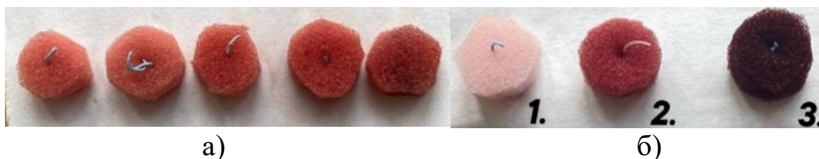
Рис. 1 – Цветовая шкала для определения железа (а) и результаты анализа воды тест-методом (б): 1) Московская область (Казанский вокзал); 2) Воронежская область (ВГПУ, ауд. 227); 3) Тульская область (скважина 1)
