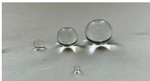
Рис. 1 – Гидрогелевые шарики до (на переднем плане) и после пребывания в воде с разной общей жесткостью (20, 10 и 5°Ж слева направо)
